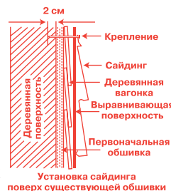
Установка сайдинга поверх существующей обшивки
